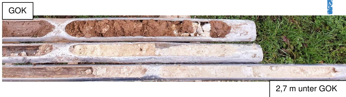
Foto 5: Bohrgut aus der Bohrung RKS 2 zwischen 0,0 m und 2,7 m unter GOK
