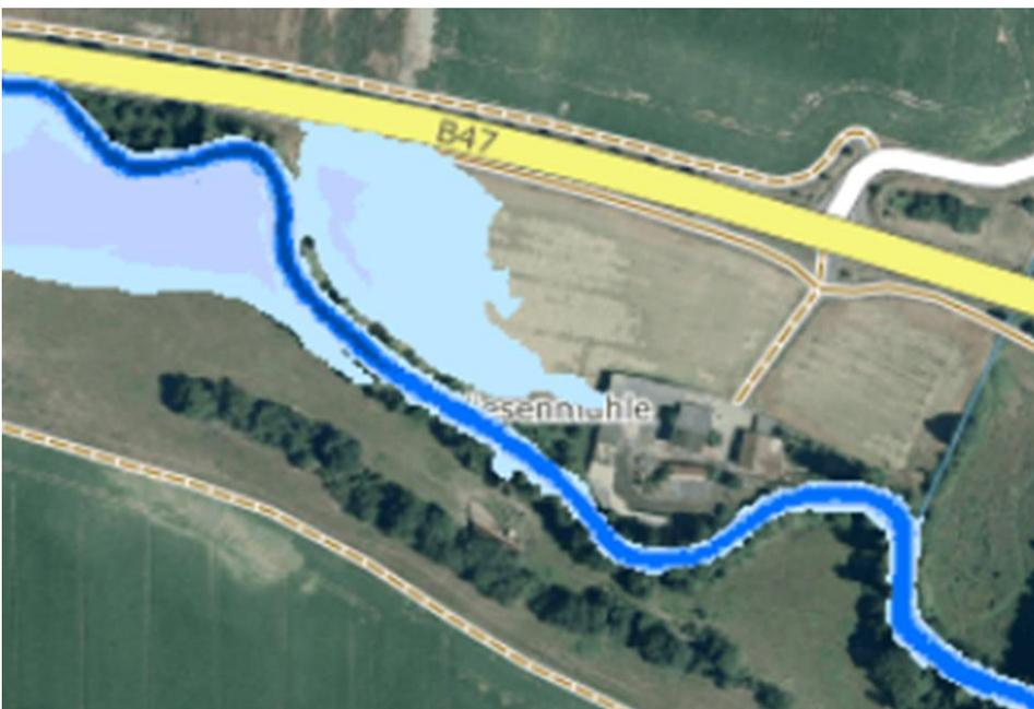
Bei einem HQ<sub>100</sub>-Hochwasser (Bild, hellblaue Fläche) ufer die Pfrimm oberhalb der Mühle in die Tal-aue aus, die Mühle ist kaum gefährdet.
