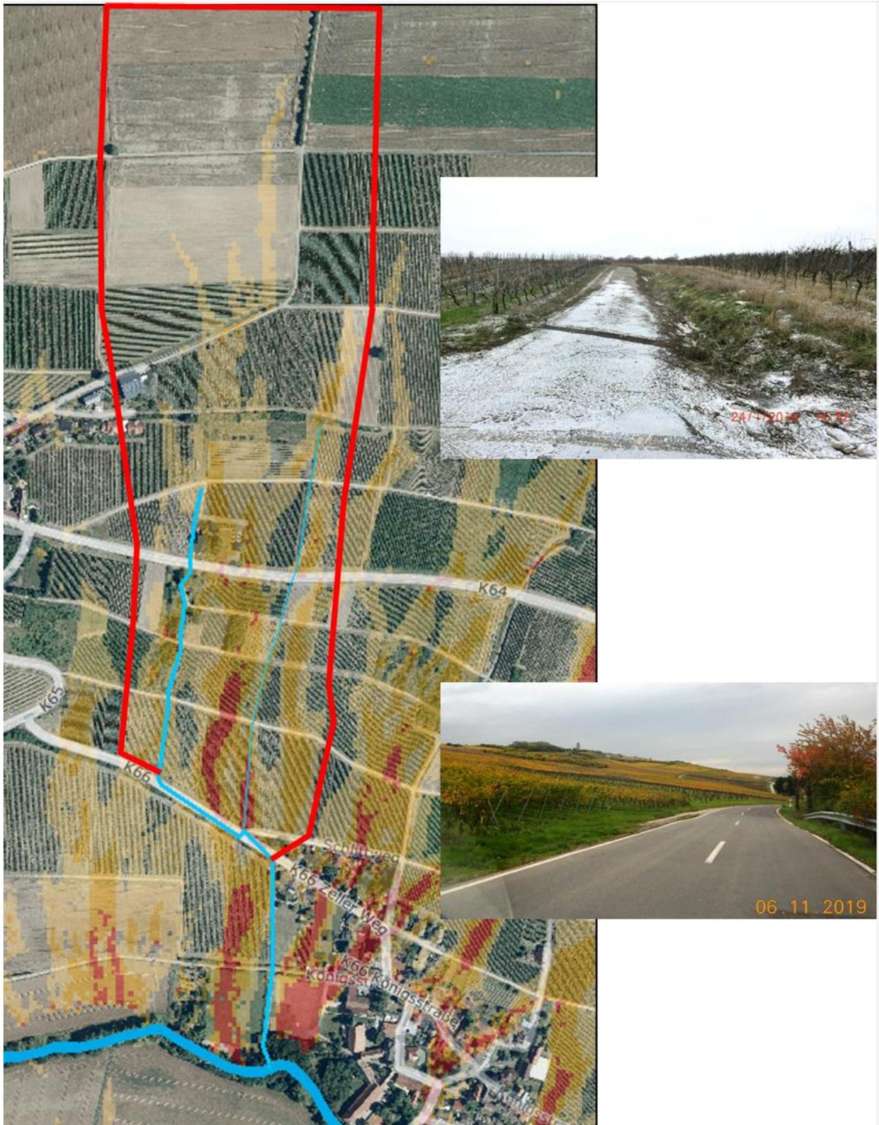
Der Flutgraben mündet planmäßig in einen Sandfang oberhalb der K 66. Die zuführende Verrohrung macht hier einen deutlichen Richtungswechsel. Bei Starkregen kommt es hier zu einer Überflutung der Kreisstraße und Sturzfluten fließen oberirdisch weiter bis zur Pfrimm.
