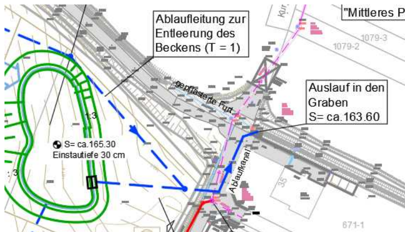
Abbildung 10-1: Ableitung in den Graben zum Ammelbach
