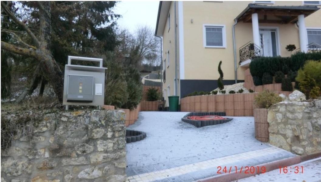
Das Wohngebäude ist in den Hang eingeschnitten mit Türen, die zur Bergseite orientiert sind. Bei einer solchen Bauweise besteht generell immer die Gefahr, dass es bei Starkregen zu Wassereintritt und Schädigung kommen kann. Die Anlieger sollten der Situation entsprechende Objektschutzmaßnahmen ergreifen und eine Elementarschadenversicherung abschließen.
