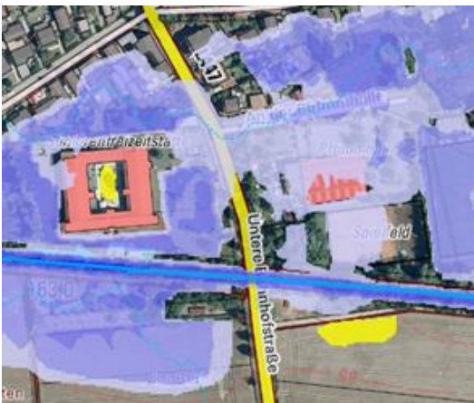
Überflutung der Unteren Bahnhofstraße bei HQ extrem
