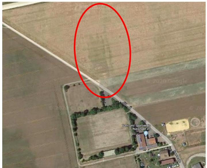
Im Bereich einer Hauptdrainage (Bild oben) kommt es bei Starkregen zu einem konzentrierten Zufluss von der Ackerfläche auf die Straße und den oberen Sportplatz. Vermutlich floss hier früher ein Bach oder zumindest ein Entwässerungsgraben (Bild links).
