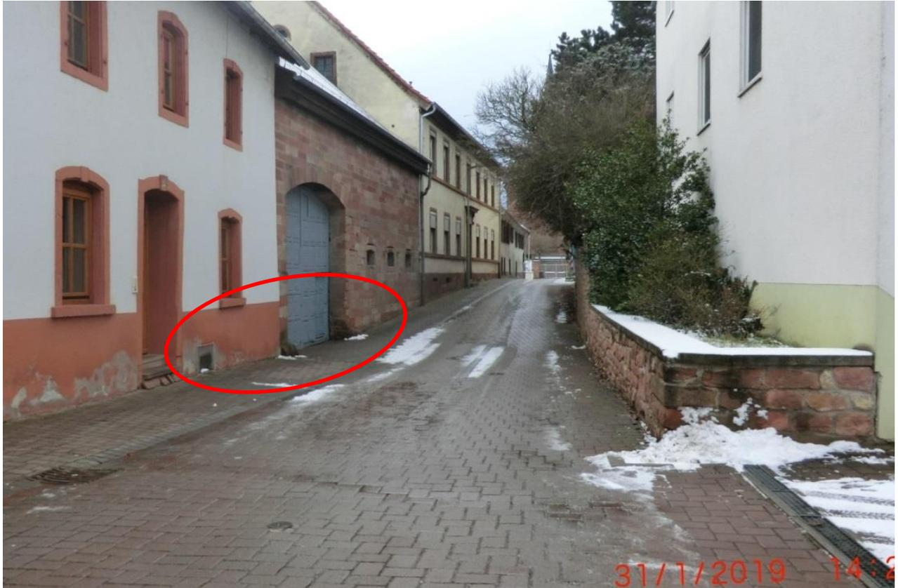
Alle tiefliegenden Gebäudeöffnungen sind überflutungsgefährdet und den Anliegern werden geeignete Objektschutzmaßnahmen empfohlen.
